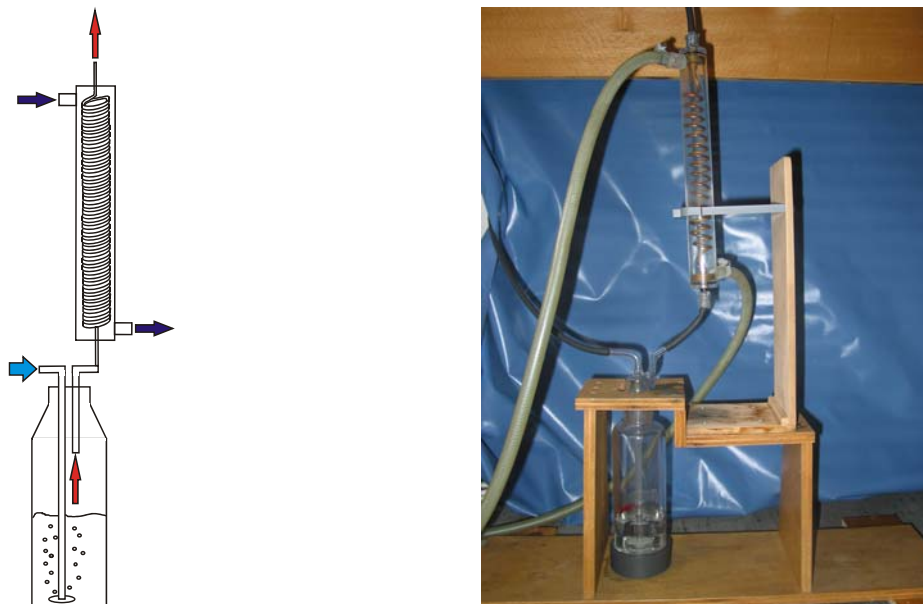
Abbildung 20: Aufbau zur Erzeugung von Toluoldampf mit definierter Konzentration über die Einstellung des Dampfdrucks in einem gekühlten Kondensator; links: schematisch, rechts: Fotografie
