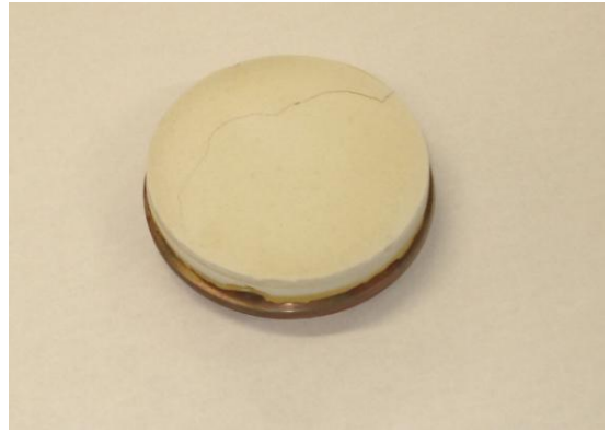
ABBILDUNG 24: GESINTERTES \text{ZnO/ZnS:Al} - SPUTTERTARGET.
