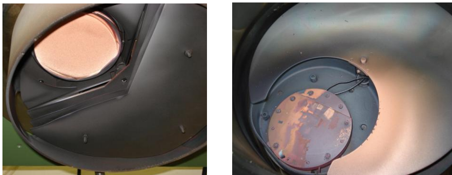
ABBILDUNG 12: FOTOGRAFIEN DES TARGETRAUMS (LINKS) UND DES SUBSTRATHALTERS (RECHTS) DER GENUTZTEN RF-SPUTTERANLAGE.
