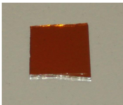
ABBILDUNG 28: FOTO DER OPTISCH ANALYSIERTEN \text{Cu}_2\text{O} -DÜNN SCHICHT.
