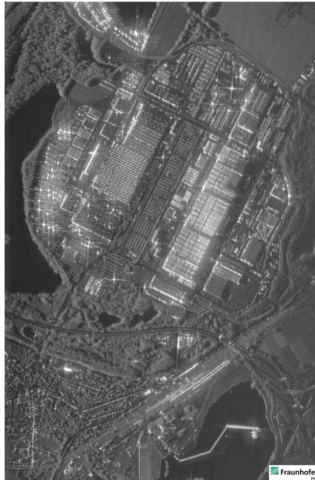
Abbildung 6: Amplituden-SAR-Bild des Mercedes-Benz Werkes in Wörth, 75 cm Auflösung, MEMPHIS.
