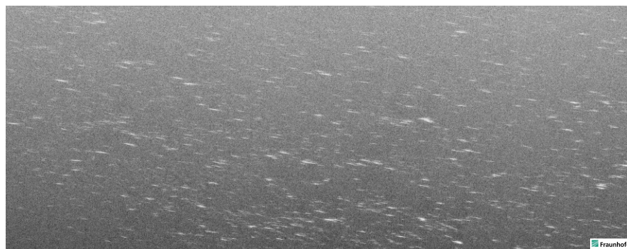
Abbildung 9: Amplituden-SAR-Bild Seeclutter in dB, 19 cm Auflösung, MEMPHIS.
