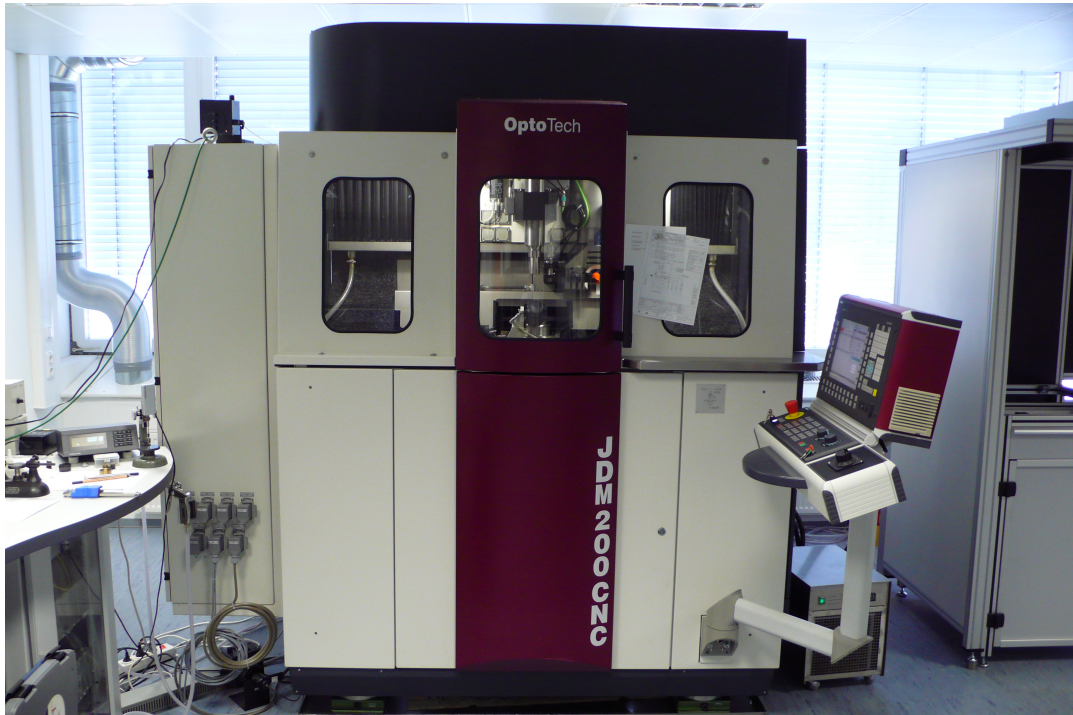
Abbildung 3.1: Der fertige Prototyp der Justierdrehmaschine JDM 200 CNC bei der Firma Leica Microsystems CMS GmbH in Wetzlar. Im mittleren Sichtfenster ist das obere Reflexbildgerät sowie die Rückseite einer der Schlaghämmer zu sehen. Der an der Maschine angebrachte Computer regelt nur den CNC-Prozess, ist jedoch nicht in der Lage die Linse zu zentrieren. Die dafür nötige Elektronik und der Messcomputer stehen auf dem linken Tisch.
