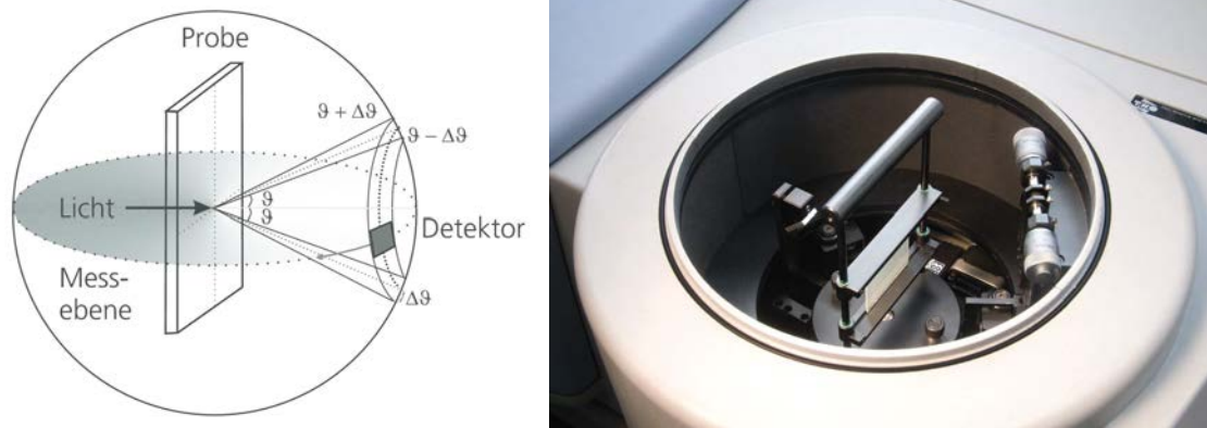
Abbildung 6.7.: Links: Das Prinzip von ARS-Messungen. Das Licht wird an der Probe gestreut und in der Messebene winkelaufgelöst mit einem Detektor vermessen. Rechts: Messaufbau am Fraunhofer IST. Eingesetzt wird eine ARTA der Firma OMT Solutions, die für das PerkinElmer Lambda950 konzipiert wurde.
