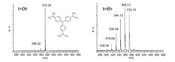
Abbildung 1 Matrix-Assistierte LDI-MS Spektren des Farbstoffes Methylviolett (M<sup>+</sup>=372.2 u) in Ethanol gelöst bevor und nachdem er sechs Stunden mit Licht bestrahlt worden ist. Fünf von sechs Abbauprodukten sind im Spektrum sichtbar (Δ=14 u). Mittels der Beschreibung der relativen Fläche eines Signales (Relative Peak Area, RPA), wobei  $A_i$  die Fläche der Signale bei m/z = i und  $A_{tot}$  die gesamte Fläche aller Signale der Farbstoffe (Molekul-Ion und Abbauprodukte) ist:
