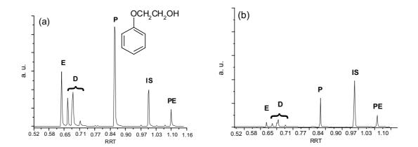
Abbildung 2 GC-MS-Chromatogramm von einem Kugelschreiberextrakt (a) bei der Zeit t = 0, (b) bei der Zeit t = 10 Tage nach der Tintenauftragung auf dem Papier. Die X-Achse stellt die relative Retentionszeit (RRT) zu dem internen Standard (IS) dar. Die Kugelschreibereintragung enthält vier Lösungsmittel: Ethoxyethoxyethanol (E), Diproylenglycol (D), Phenoxyethanol (P, Strukturformel) und Phenoxyethoxyethanol (PE).
