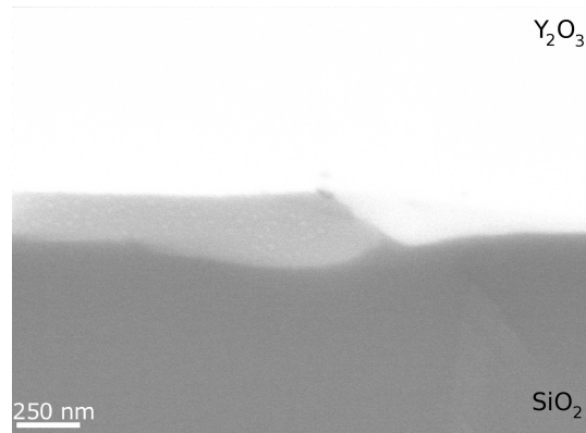
Abbildung 4.6: Querschnitt einer \text{Y}_2\text{O}_3 -Schicht auf \text{SiO}_2 nach 50 Stunden bei \vartheta = 840\text{ }^\circ\text{C} bei einer angelegten Spannung von 100 V. Die Kathode liegt an der \text{Y}_2\text{O}_3 -Schicht an. Die \text{Y}_2\text{O}_3 -Schicht ist überbelichtet, da der Kontrast zwischen der natriumhaltigen Schicht \text{SiO}_2 und dem undotierten \text{SiO}_2 nicht sehr groß ist.
