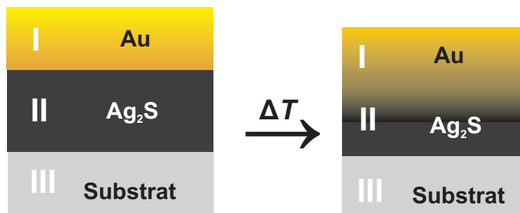
Abb. 7.44: Schema zur Verschiebung der Goldschicht durch Zersetzung der Silbersulfidschicht während des Aufheizens.
