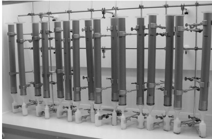
Abbildung 4-1: Versuchsaufbau der Sickerversuche im Labor.
