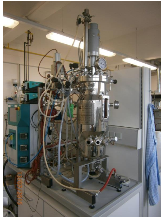
Abbildung 2.14: Fermentationseinheit für die Biotransformation von Bretax CI mit G. trabeum .
