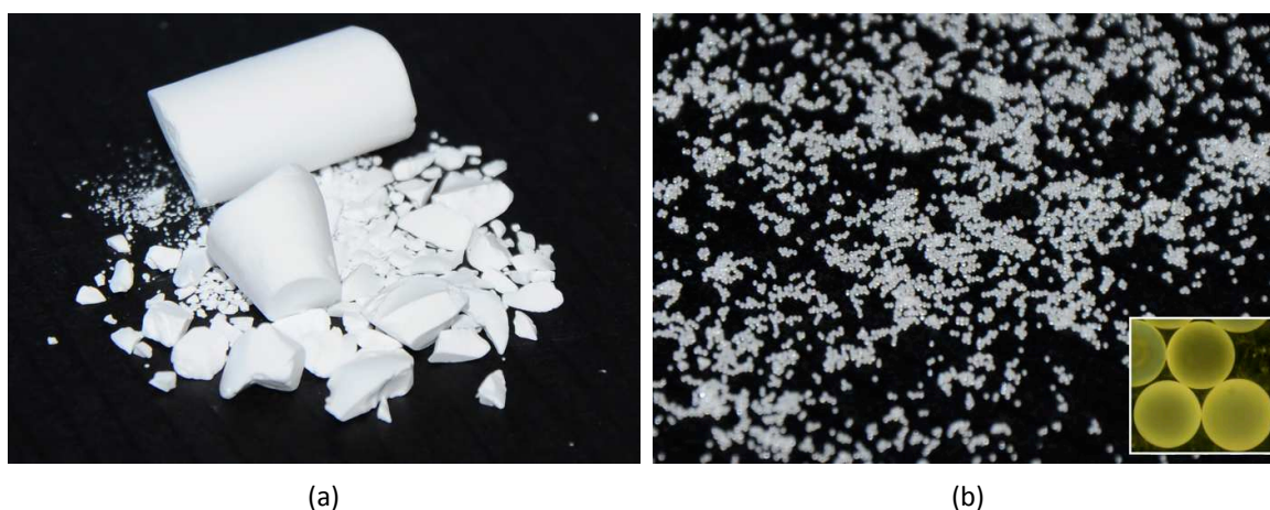
Abbildung 2.1: Materialien, die zur Immobilisierung von MsP1 verwendet wurden: (a): Bruchstücke des funktionalisierten Silica-Monolithen; (b): funktionalisierte Polystyrol-Kugeln in 300-facher Vergrößerung (kleines Bild)
