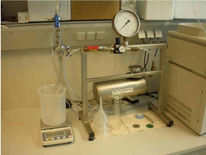
Abbildung 4-2 Kleinmengenfiltrationsstand zur Schichtenfiltration
