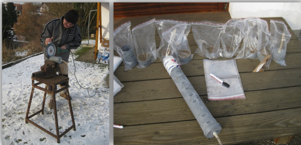
Abbildung 3-5: Verlagerung von Antibiotika in Bodenschichten. Erhalt der Bodenproben durch Zersägen der Lysimeterrohre im Abstand von 5 cm.
