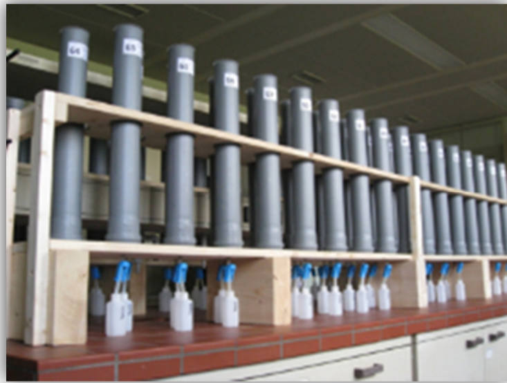
Abbildung 3-4: Lysimeterrohre im Labormaßstab. Versuchsaufbau beim LHL Eichhof in Bad Hersfeld.
