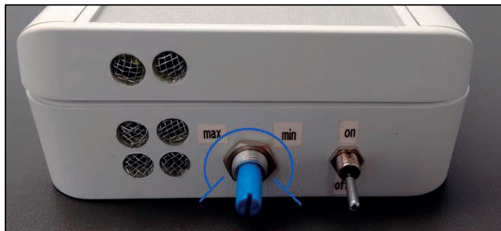
Abbildung 17: Steuerung des Verneblersystems. Sichtbar: Drehwinkel des Drehpotentiometers (blau) und ON/OFF-Schalter.
