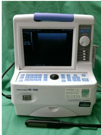
Abbildung 3: Portables Ultraschallgerät Honda HS-1500 der Firma Honda Electronics Co. zur Durchführung der Graustufenanalyse
