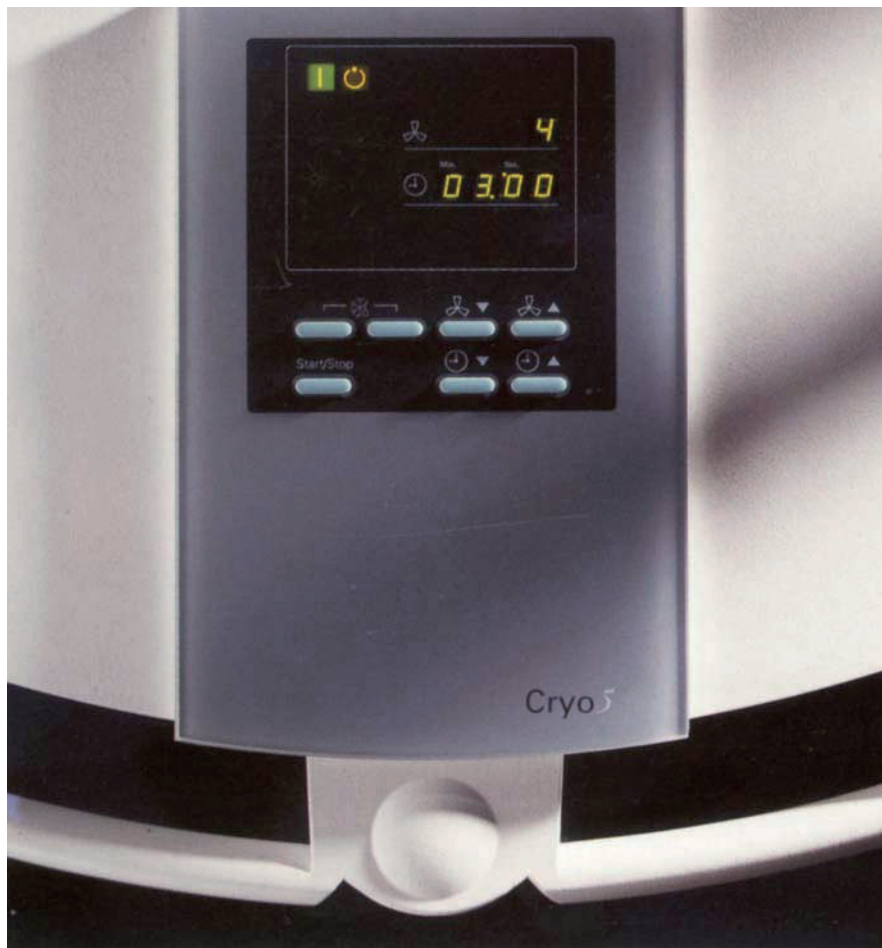
Abbildung 2: Bedienfeld des Kaltluftapplikators Cryo-5® der Firma Zimmer Elektromedizin GmbH, Deutschland, einstellbar sind die Strömungsgeschwindigkeit von Stufe 1 bis Stufe 2 sowie die Applikationsdauer
