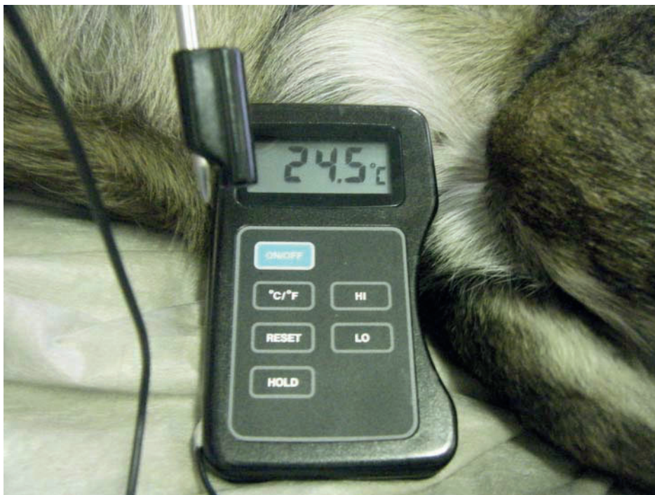
Abbildung 3: LCD-Handthermometer mit Einstechfühler DT-250 der Firma Conrad Electronic GmbH, Deutschland
