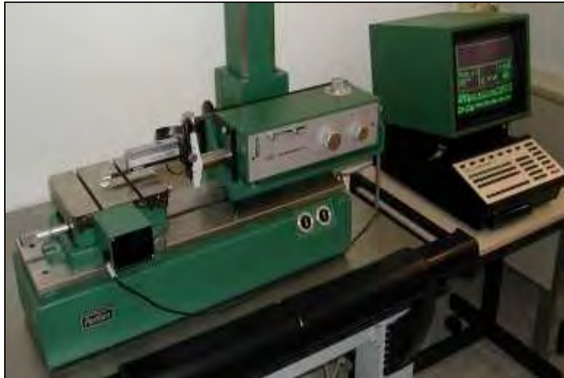
Abb. 9: Arbeitsplatz am Perthometer S8P. Die Messapparatur befindet sich auf einem schwingungsgedämpften Messtisch.
