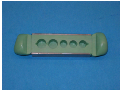
Abb. 4.8 und 4.9: Abformung nach Abnahme vom Modell und nach Entfernung der Überschüsse sowie mit Abflussrillen
