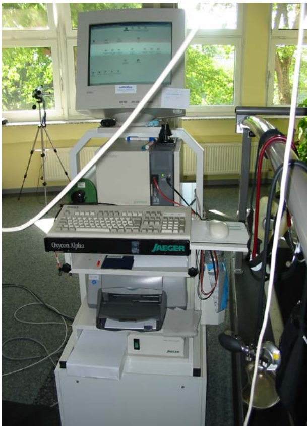
Abb. 5: Modernster Spiroergometriemessplatz „Oxycon“ der Firma E. Jaeger im Institut für Prävention und Sportmedizin (IPUS), Bad Wildungen
