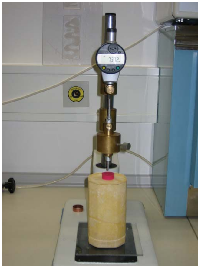
Abb. 6: Versuchsaufbau nach DIN ISO 48 zur Ermittlung der Kugeldruckhärte (ohne Druckplatte)
