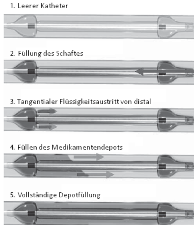
Abbildung 2.2: Schematische Darstellung des Funktionsprinzips eines Genie-Ballonkatheters
