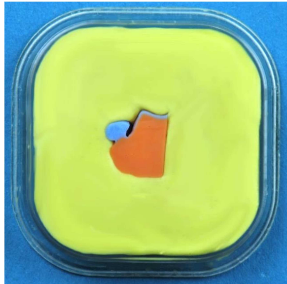
Abb. 18: Schnittstück in Puttymasse eingebettet
