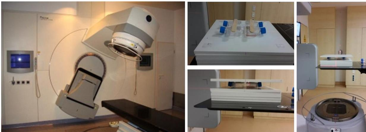
Abbildung 3: Elektronenlinearbeschleuniger Elektra Synergy und Aufbau der Bestrahlungsversuche. Die Zellkulturflaschen T12,5 wurden auf fünf 10 mm hohen RW<sub>3</sub>-Platten mit wasser-äquivalenter Dichte (RW<sub>3</sub>: 1,045 g/cm<sup>3</sup>, Wasser: 1,0 g/cm<sup>3</sup>) positioniert. Die Holzschaber dienen dabei nur der besseren Stabilität und der richtigen Höhe auf der die sechste RW<sub>3</sub>-Platte positioniert wurde.
