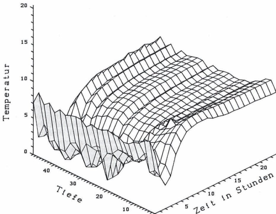
Bild 2: Schema der Temperaturveränderungen im Untergrund nach kurzfristigem Wärmeentzug
