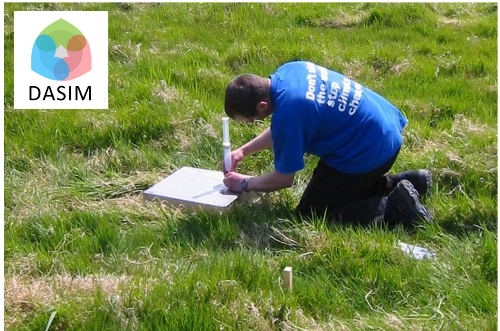
Probenahme von Bodenluft
