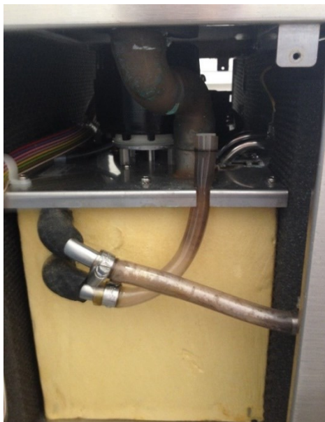
Abbildung 20: Verfärbungen der Tankschläuche
