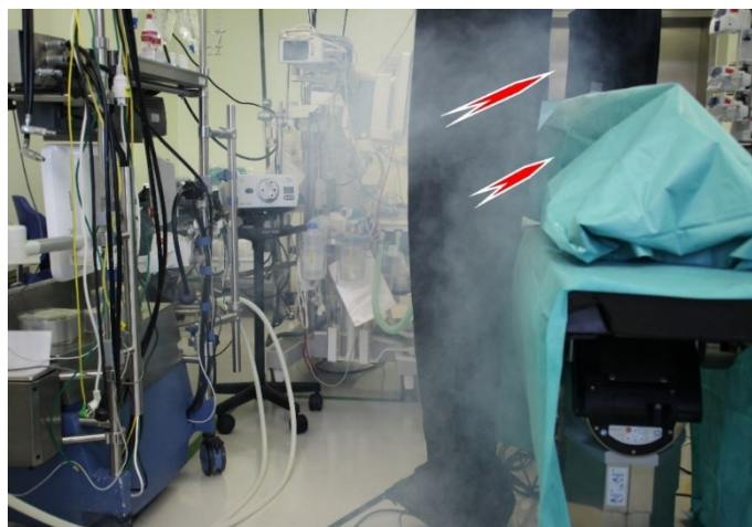
Abbildung 39: Fußseitiges Eindringen von Nebel ins OP-Gebiet
