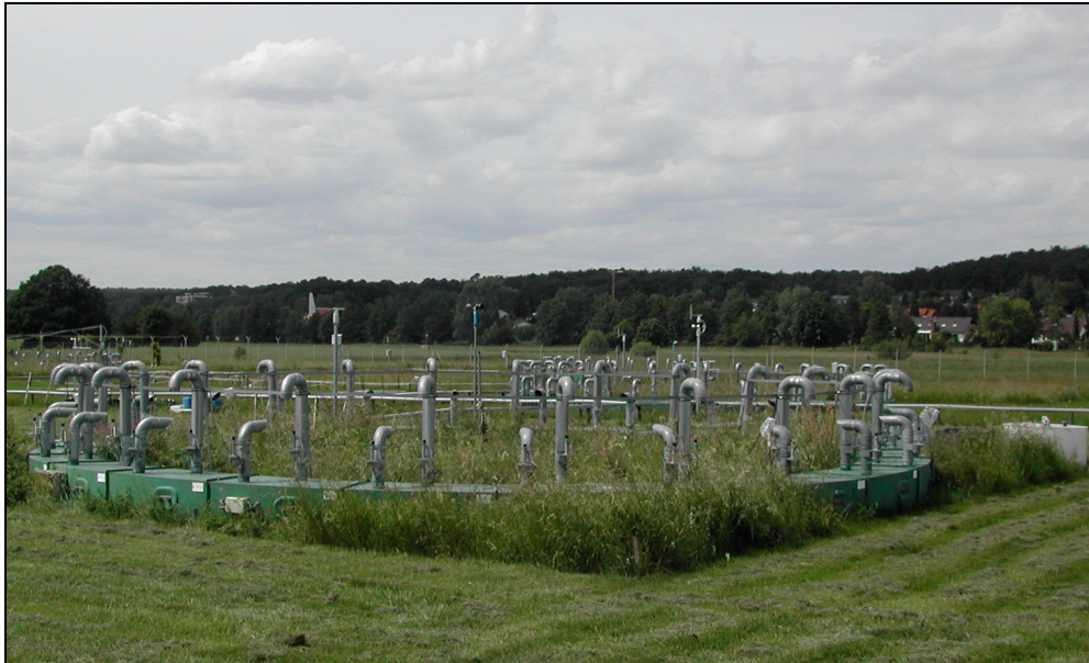
Abb. 8: Gießener Freiland-CO 2 -Anreicherungsexperiment (FACE = Free Air CO 2 Enrichment) Block 3: vorne E3, hinten A3, E: erhöhte CO 2 -Konzentration, A: aktuelle CO 2 -Konzentration
