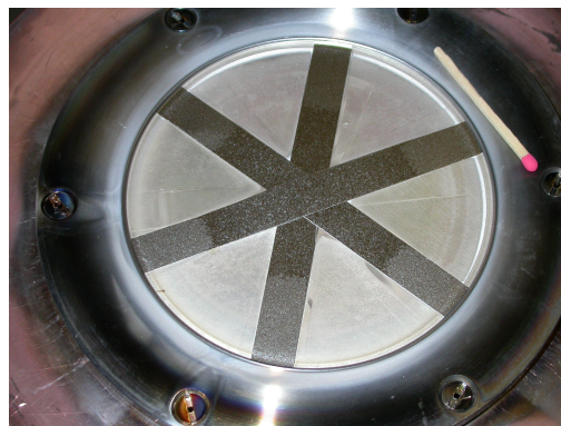
Abbildung 6.3: Magnesium-Target mit Nickelstreifen
