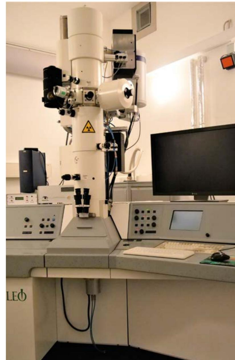
Abb. 98: Das Transmissionselektronenmikroskop der Imaging Unit.
