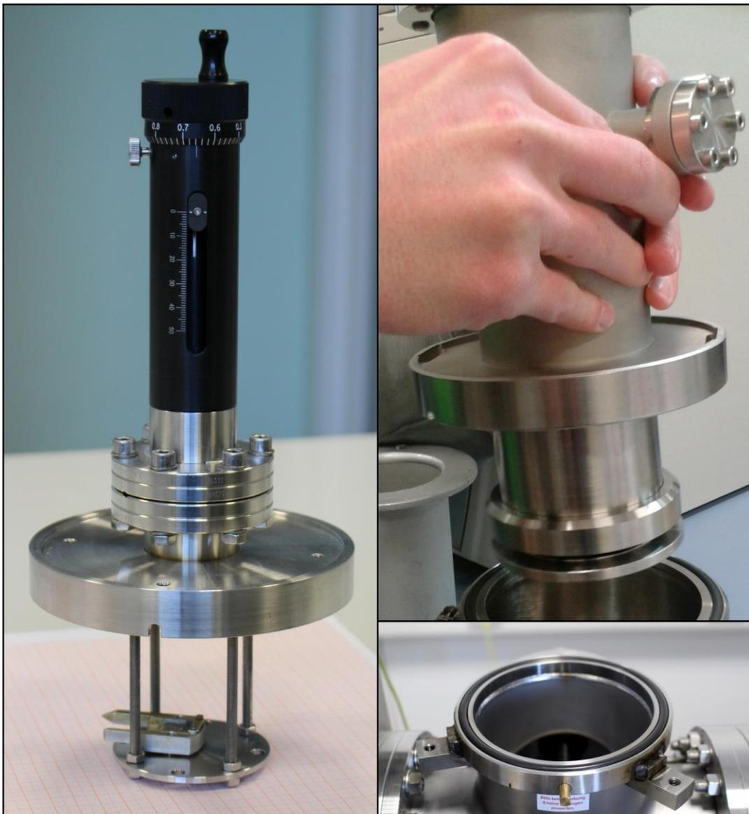
Abbildung 3.2: Foto des nativen Schleusensystems (links), des Transfermoduls der Firma *Prevac* (rechts, oben) und des Viton-gedichteten Flansches an der Transferkammer des Rasterkraftmikroskops (rechts, unten).
