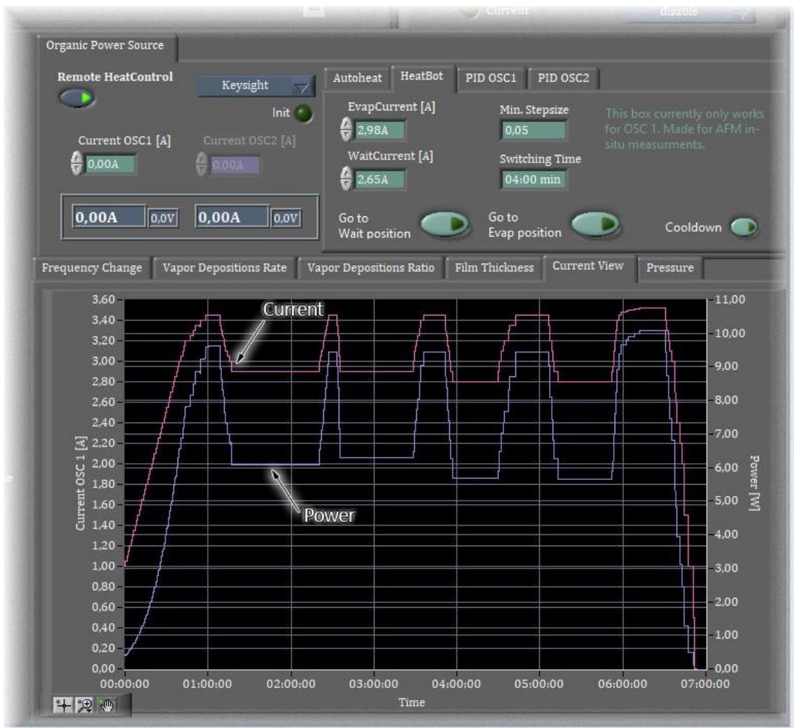
Abbildung 3.5: Darstellung des *LabView*-Programms „*Vaclab v16*“ mit der Funktion „*HeatBot*“, dem Fenster „*CurrentView*“ und einer Beschriftung von Strom und Leistung.
