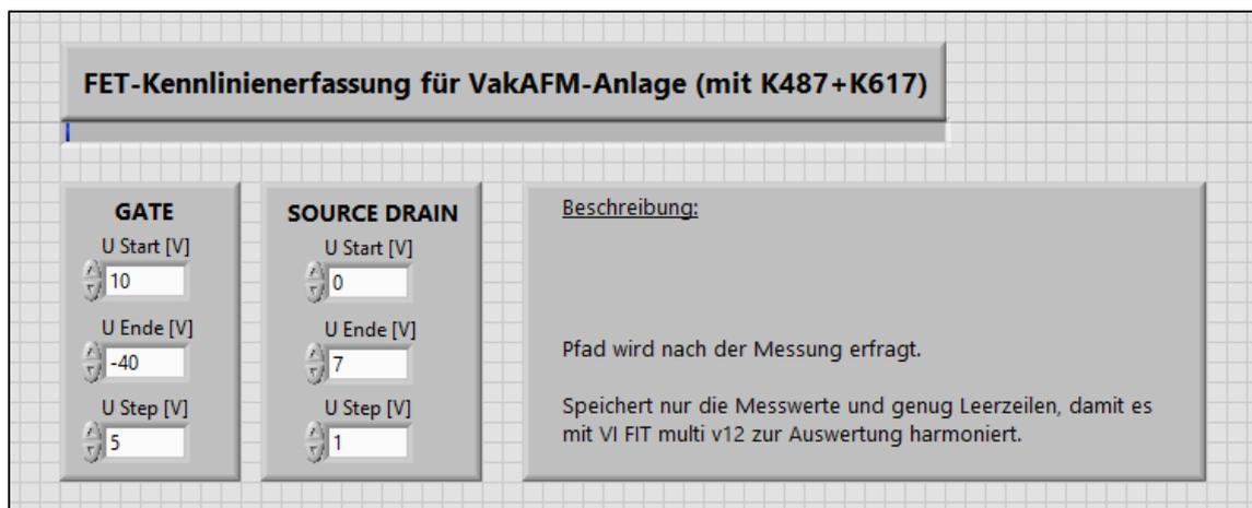
Abbildung 3.8: Interface des Programms zur OFET-Kennlinienerfassung.
