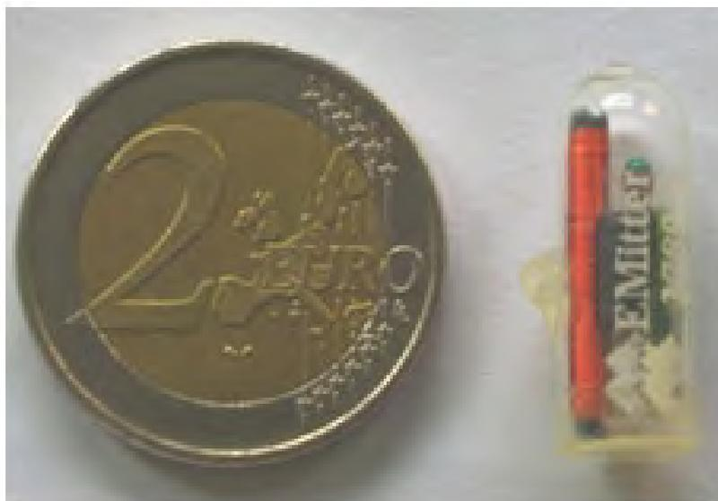
**Abb. 19: Telemetrischer Sender (Typ T-4000 E-Mitter®)**
