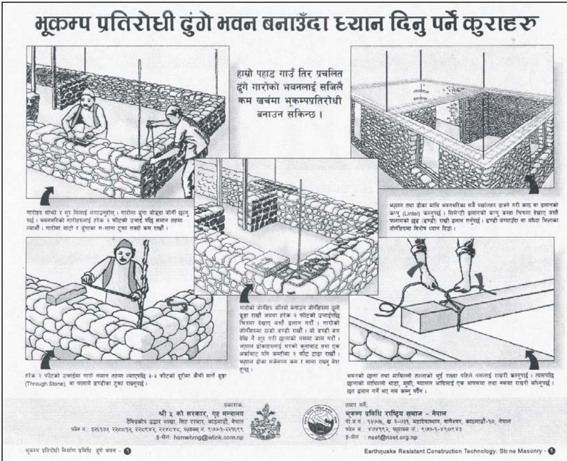
Abb. 13: Schematische Darstellung zur erdbebensicheren Errichtung von Gebäuden (DIXIT et al., 1999)
