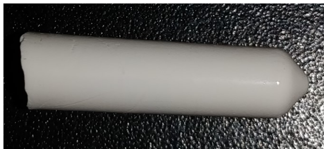
Abbildung 4.4-7: Mit Ludox-Partikeln infiltrierter, gesintertter \text{SiO}_2 -Monolith \text{SiO}_2 -MNP-NS.
