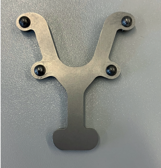
Abb. 4.2: Positionierungsplatte inklusive eingesetzter Messkugeln
