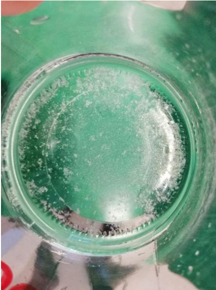
Abb. 14: Auskristallisation von Salzen in den Succinat-Varianten im ersten und zweiten Perkolationsversuch.
