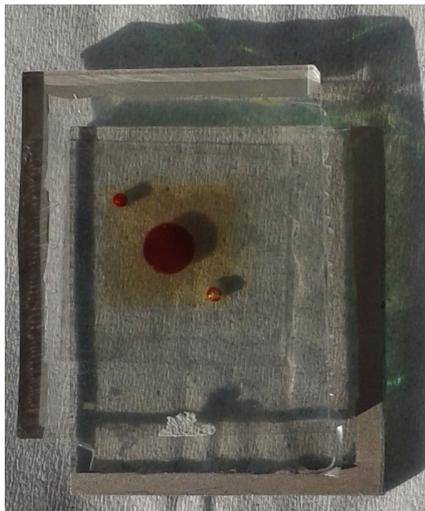
**Abbildung 3.2** – Bild einer farbstoffsensibilisierten Solarzelle. In der Mitte ist das sensibilisierte ZnO zu sehen, welches kreisförmig elektrochemisch abgeschieden wurde. Umgeben ist die sensibilisierte Schicht von einem Redoxelektrolyten, der gelblich erscheint. Der Elektrolyt steht im Kontakt zu einer kompakten Schicht ZnO. Über die beiden Bohrlöcher, welche in den beiden Ecken zu sehen sind, wurde der Elektrolyt in die Zelle eingefüllt.
