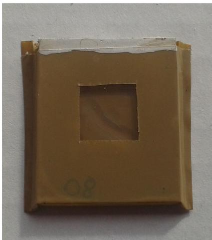
**Abbildung 4.44** – Probe die mittels Klebeband für die Cyclovoltammetrie maskiert wurde.
