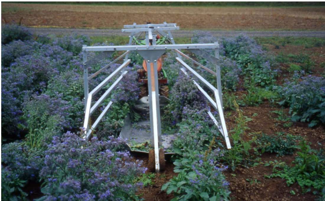
Abb. 3 Prototyp (Nr.1) für ein Gerät zur Samenernte von Borretsch
