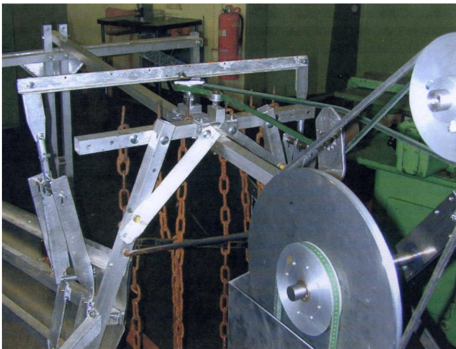
Abb. 5 Erntegerät (Prototyp 3) – Schüttelmechanismus und Rüttelketten
