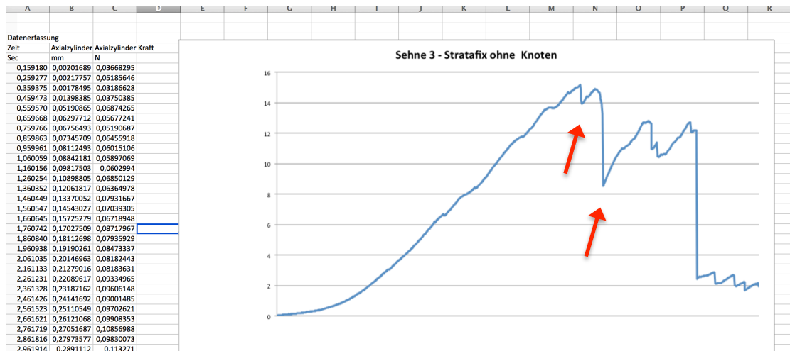
Abbildung 39: Exemplarische Darstellung einer Kraft-Zeit-Kurve bei einer modifizierten Zechernahrt mit dem Stratafix-Faden. Typisch ist hier nach annähernd linearem Kraftanstieg, dass regelhaft kein plötzliches und totales Nahtversagen eintritt, sondern der Faden aus der Sehne herausgezogen wird, aber durch ein Wiedereinhaken der Widerhaken in der Sehne nochmals ein Kraftaufbau erfolgt (rote Pfeilmarkierung). Auch hier zeigen sich durch „Resthalten“ des Fadens zum Versuchsende noch marginal positive Kraftwerte.
