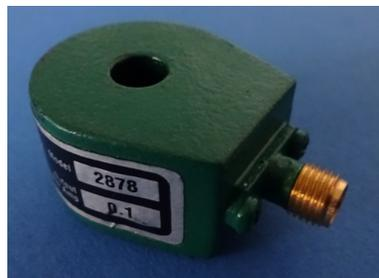
**Abb. 5.9.:** Eingesetzter Stromsensor zur Messung des Spulenstromes (Sensormodell 2878 der Firma „Pearson“)
