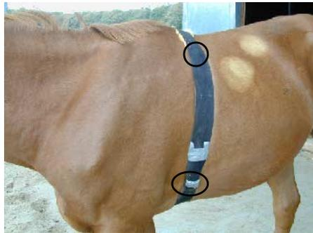
**Abbildung 18: Positionierung der Messvorrichtung und der Elektroden (Kreissymbole) am Pferd**
