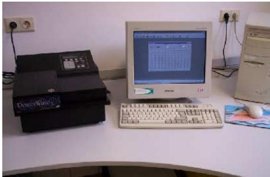
**Abbildung 24: Mikrottestplatten-Photometer**
