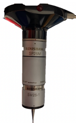
Abbildung 3.16 Messtastersystem (SP25M), mit Tastereinsatzhalter (SM25-1) und Rubintastkugel (d=1mm)
