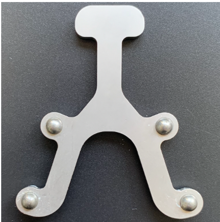
Abbildung 3.4 Unterseite der Positionierungsplatte mit Messkugeln
