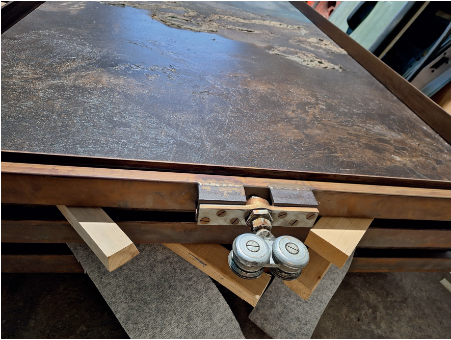
Abb. 10: Hein Heckroth, Bühnenrückwand aus dem Bürgerhaus Biedenkopf, Rollapparat für das Faltschiebesystem, 1970, Privatbesitz (Foto: Marcus Kiefer, Gießen)
