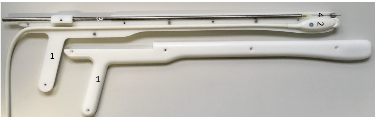
Abbildung 8: Sondenträger 1 mit Ultraschallsonde 2 , Metallführstab 3 und aufgesetzter Kanüle 4
