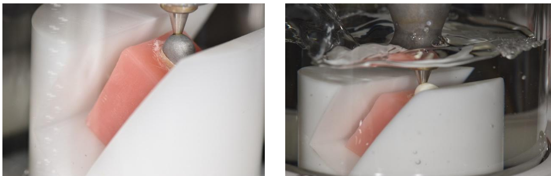
Abbildung 15: Nicht axiale Belastung der Stumpfanteile bei einem gegossenen (links) und einem glasfaserverstärkten CAD/CAM-Komposit Stiftaufbau (rechts) im Kausimulator unter Thermowechselast im Wasserbad.
