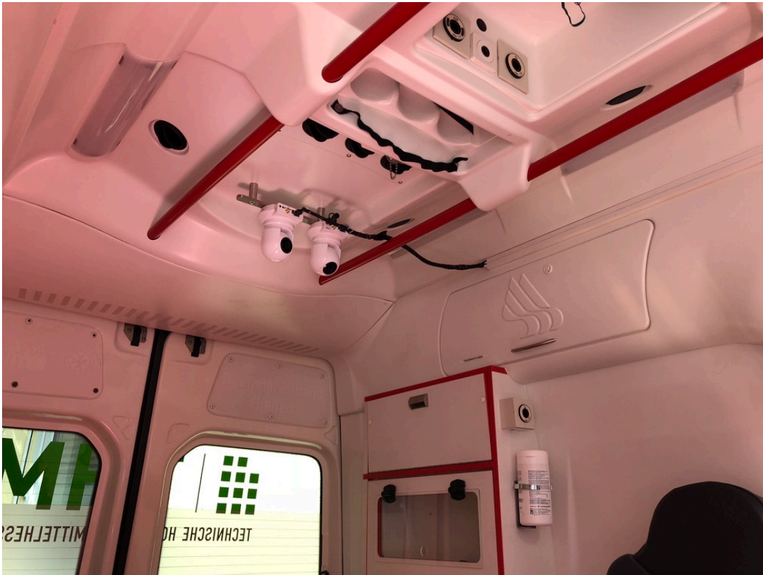
Abbildung 4.7 Positionierung der Kameras (inkl. Ersatzkamera) während des Betriebes im Rettungswagen, eigene Darstellung
