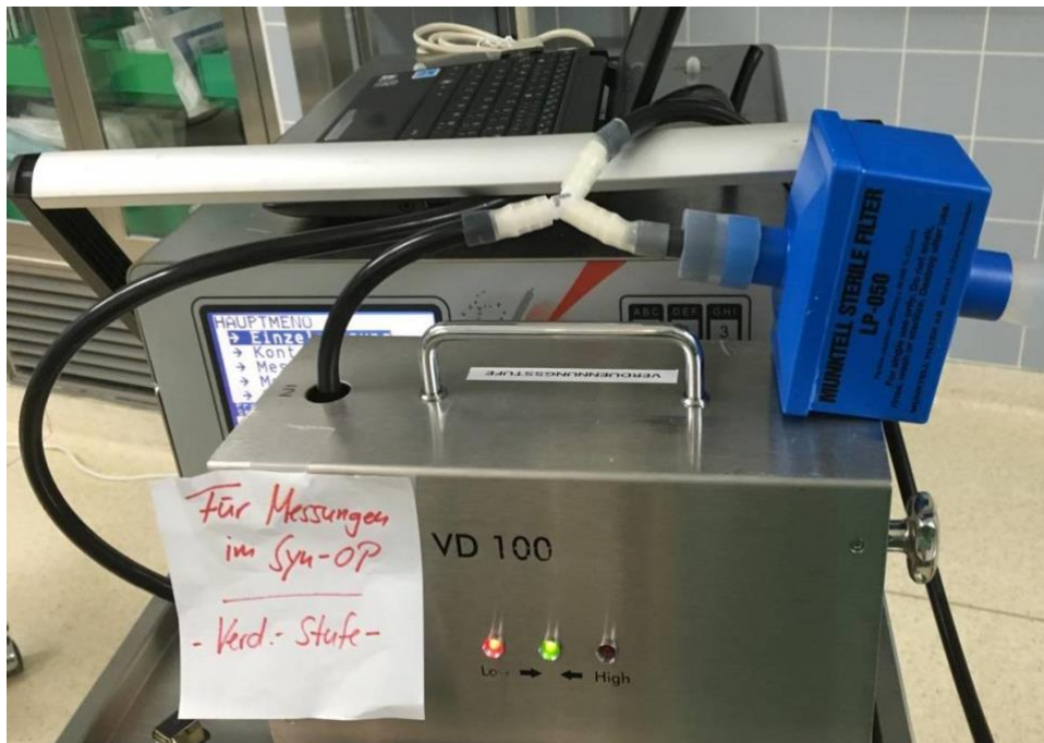
Abbildung 5: Anschluss des antistatischen Schlauchs an einen Schenkel des Y-Stücks, Sterilfilter (blau) am anderen Schenkel des Y-Stücks, Verbindungskabel zur Verdünnungsstufe 100 (eigene Aufnahme)
