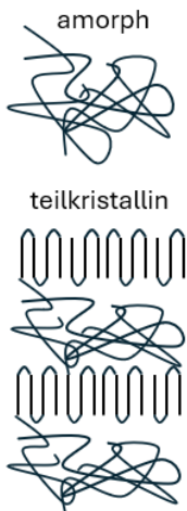
Abbildung 2.1 Elastomere sind chemisch schwach vernetzte Polymere, die wie Thermoplaste und Duromere eine Klasse der Polymere bilden. (graphische Darstellung in Anlehnung an [27])
