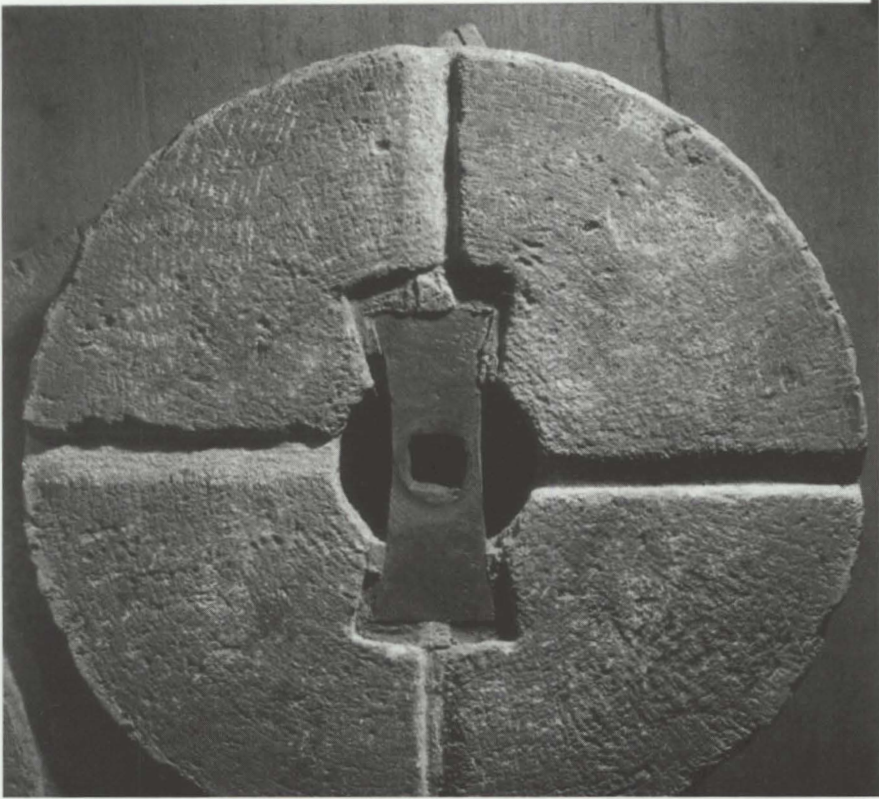
Abb. 4 Ein Läuferstein von 81,5 cm Durchmesser im Freilichtmuseum Anzenaumühle bei Bad Goisern in Oberösterreich. Die Haue ist in ihrer passenden Vertiefung des Läufersteins zunächst durch zwei kleine Holzkeile oben und unten fixiert und danach mit Blei ausgegossen worden. Foto: Azzola
