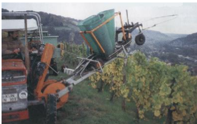
Abbildung 13: Selbstlenkender Geräteträger mit Transportfläche (DIETRICH 1995 S. 31)
