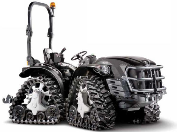
Abbildung 7: Knickgelenkter Traktor MACH 4 mit Gummilaufwerk (ANTONIO CARRARO 2012 S. 3)
