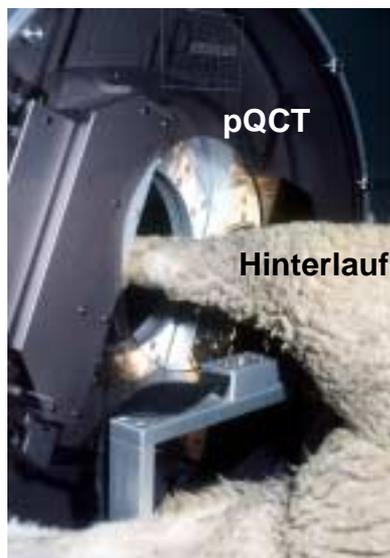
Abb. 3.10 Blick auf den eingespannten Hinterlauf während einer Messung im pQCT
